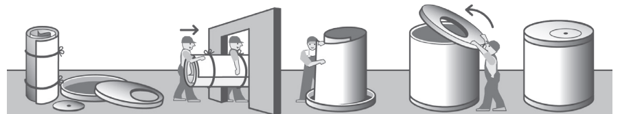
Haase kommt. Bringt die Teile in den Keller. Baut den Tank auf. Fertig!
